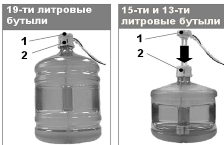
Рис.4. Установка сифона на бутылки с водой
