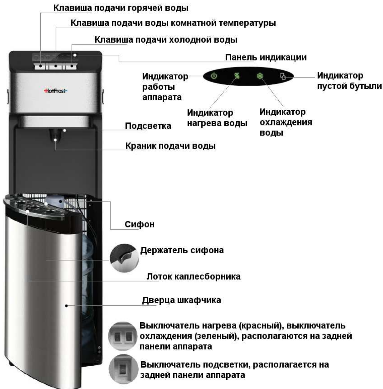
Рис.1 (с) Схема аппарата 40А (S,N)
